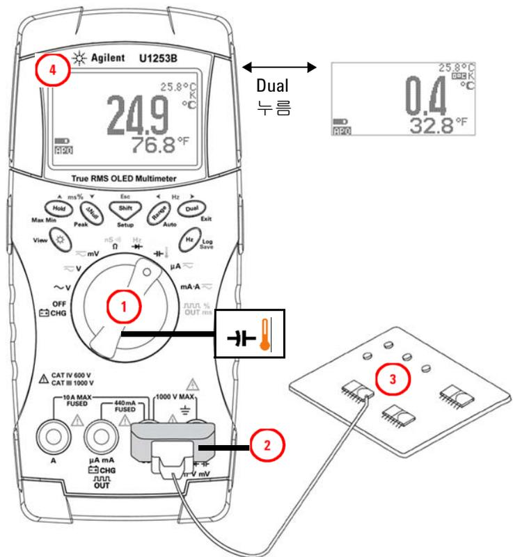
그림 2-17 표면 온도 측정
