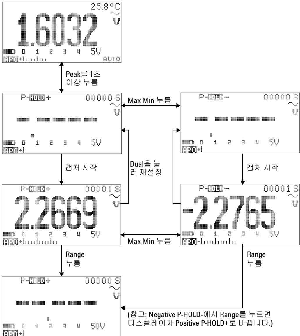
그림 3-7 1 ms Peak Hold 모드 작동
