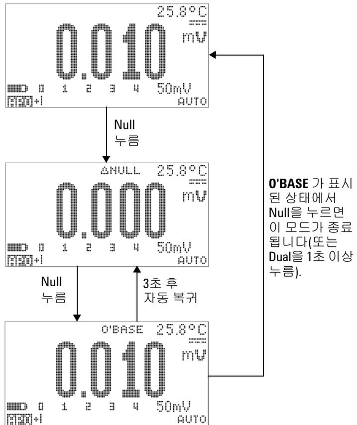
그림 3-4 Null ( 상대 ) 모드 작동
