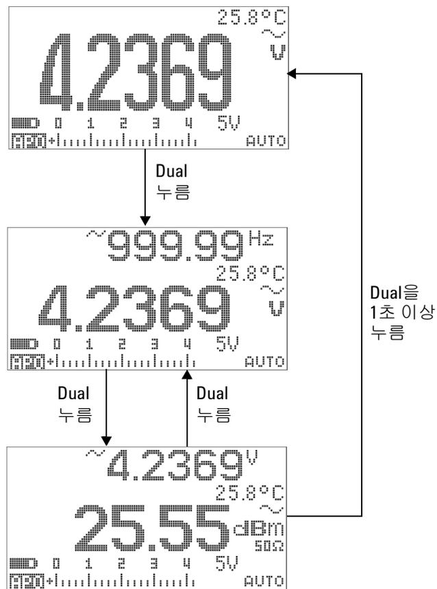
그림 3-5 dBm 표시 모드 작동
