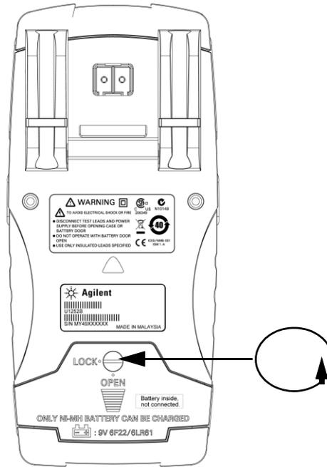
그림 5-2 Agilent U1253B True RMS OLED 멀티미터의 후면판
