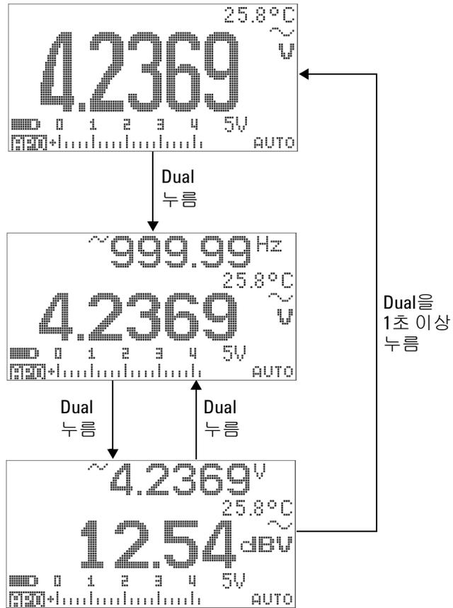
그림 3-6 dBV 표시 모드 작동
