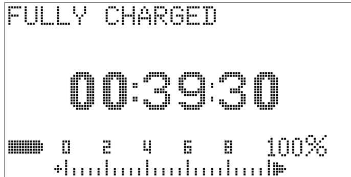
그림 5-6 완전 충전 및 세류 상태
