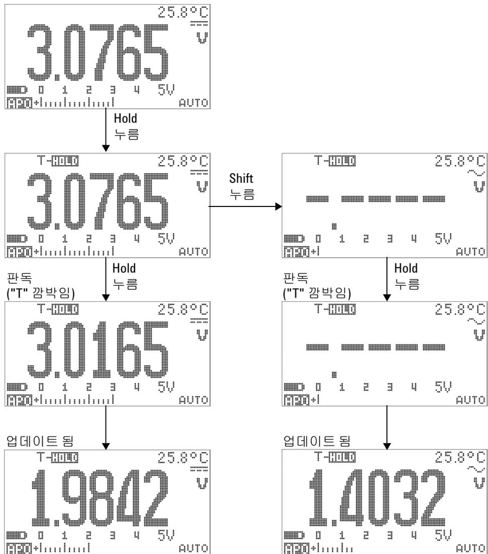
그림 3-2 Data Hold 모드 작동
