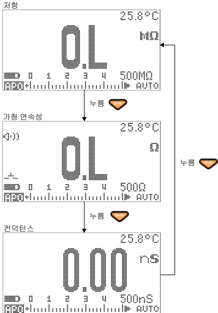
그림 2-9 저항, 가청 연속성, 컨덕턴스 테스트
