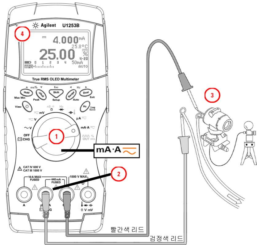
그림 2-4 4mA ~ 20mA 측정 스케일
