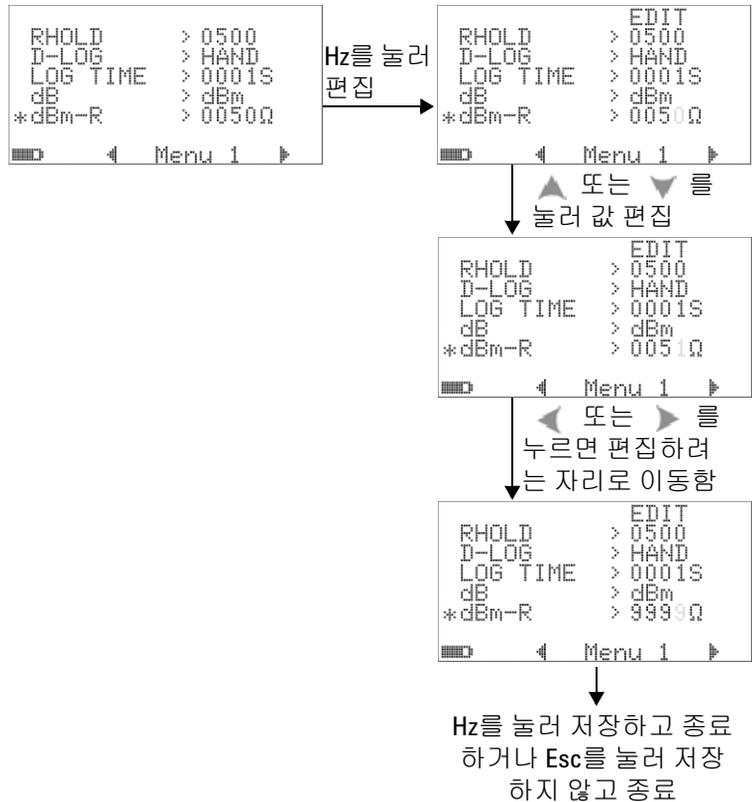
그림 4-6 dBm 단위에 대한 기준 임피던스 설정
